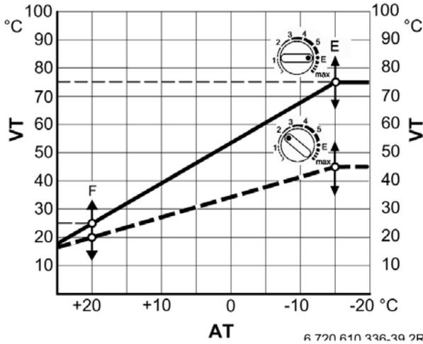
— Réglage en usine: P. ex. chauffage par radiateurs avec une température de départ de max. 75°C
